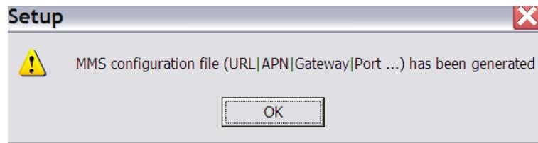
Inserte la tarjeta SD en la cámara con el programa setup.dat en el directorio raíz. A continuación desplace el interruptor a la posición TEST para entrar en modo de prueba. Un mensaje se mostrará en la pantalla LCD "Updated Successfully", lo que indica la función MMS se ha establecido con éxito.
