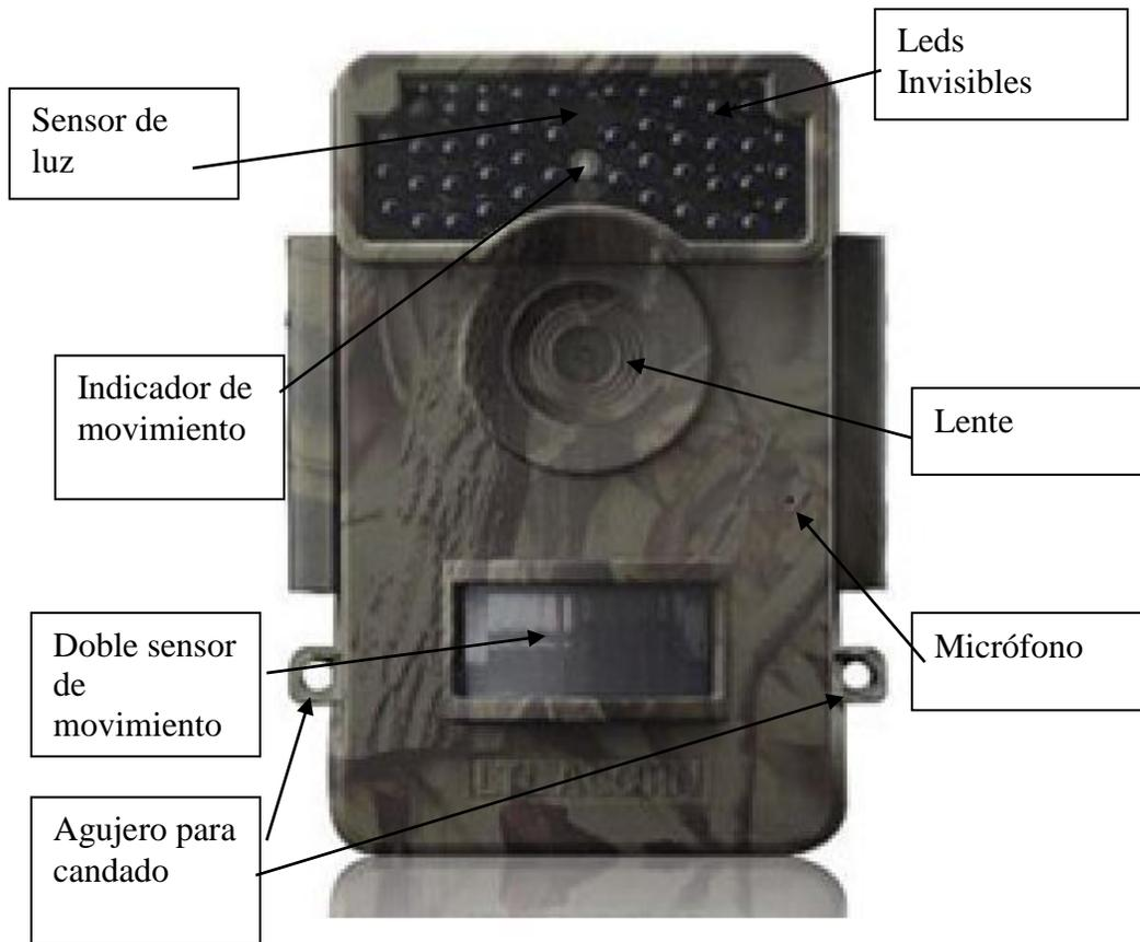
**Atención:** la lente de la cámara dispone de un filtro para tomar fotos por el día y por la noche. Cuando la cámara está apagada, este filtro está suelto y es posible incluso verlo a simple vista. Sin embargo, cuando la cámara se enciende, este filtro se coloca completamente o se quita totalmente según las condiciones de luz existentes. Esto forma parte del funcionamiento normal de la cámara
